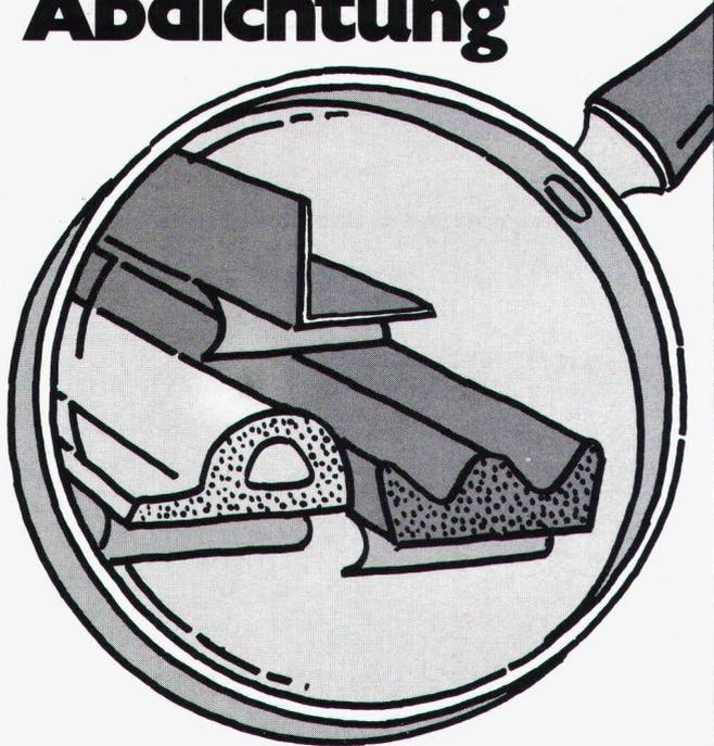
Die selbstklebenden Dichtungsprofile aus Polypropylen und APTK\*Schaumstoff lösen Ihre Dichtungsprobleme an Türen und Fenstern.
