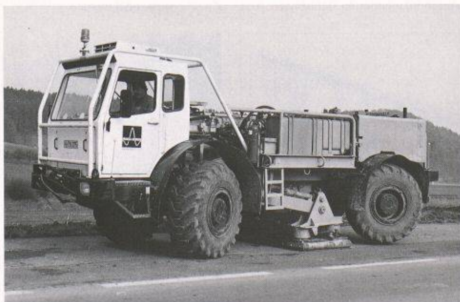
Einer der drei in der Nordostschweiz eingesetzten Vibratoren. Die geländegängigen Fahrzeuge haben ein Gewicht von je 16 t. In der Arbeitsstellung lasten davon max. 75% auf einer hydraulisch absenkbaren Grundplatte, die elektronisch gesteuert genau definierte Schwingungen erzeugt im Frequenzbereich zwischen 8 und 120 Hertz. Das Signal («Sweep») dauert 12 Sekunden. (Bild Nagra)
