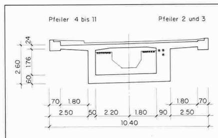
Bild 6. Querschnitt über den Stützen mit Kabelumlenksätteln
