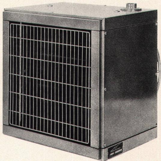
Für das schnelle und wirksame Trocknen von Wäsche ist es wichtig, daß eine rege Umwälzung von Warmluft im Trockenraum geschaffen wird. Der Warmluftapparat besteht aus einem Axialventilator mit 2 Geschwindigkeiten und einem Wärmeaustauscher für Warmwasser, welche in einem Stahlblechgehäuse eingebaut sind, sowie einem Satz Montageeisen zum Befestigen des Wäschetrockners an der Wand. Gehäuse und Montageeisen sind mit grauem Hammerschlaglack gestrichen.
