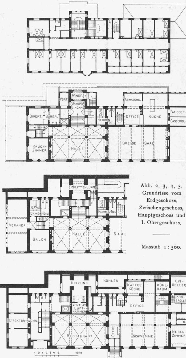
Abb. 2, 3, 4, 5. Grundrisse vom Erdgeschoss, Zwischengeschoss, Hauptgeschoss und I. Obergeschoss.
