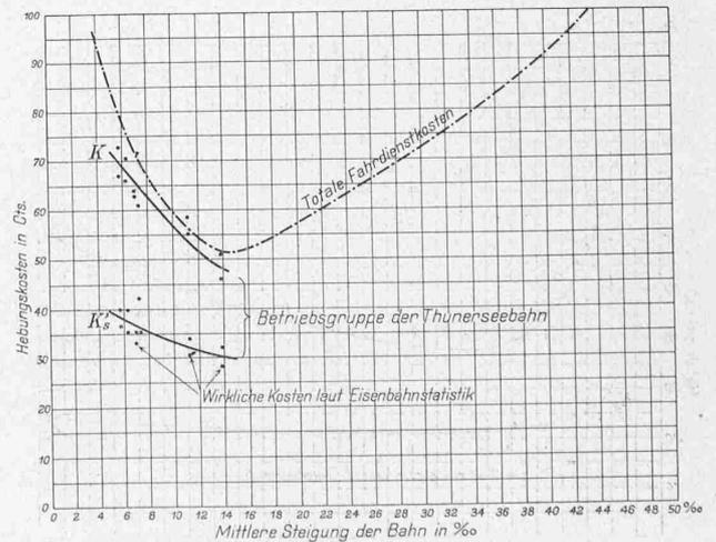
Diagramm 2. Hebungskosten für 1000 t auf 1 m Höhe. (Strichpunktierte Kurve für 1000 mt Bruttolasten.)
