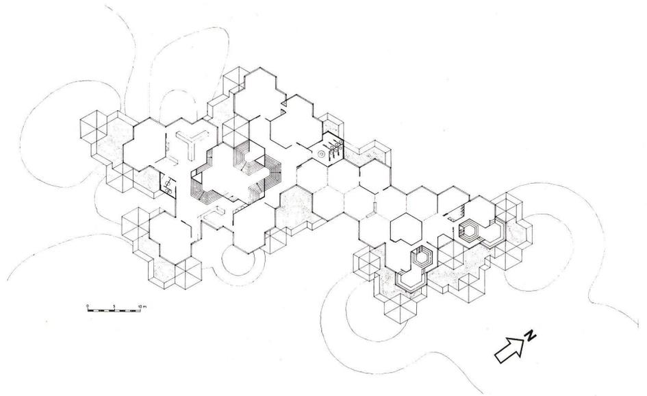
Die hier im Entwurfsstadium gezeigte Schule besteht aus der Addition zweier Polyeder, deren Grundfläche sechseckig ist. Die Schule ist zur Zeit noch im Bau und wird auf Beginn des kommenden Schuljahres hin fertiggestellt sein. Die Tragstruktur wurde aus verleimten Holzbalken erstellt, die Dach- und Fassadenflächen bestehen aus farbig beschichteten Sandwich-Platten.
