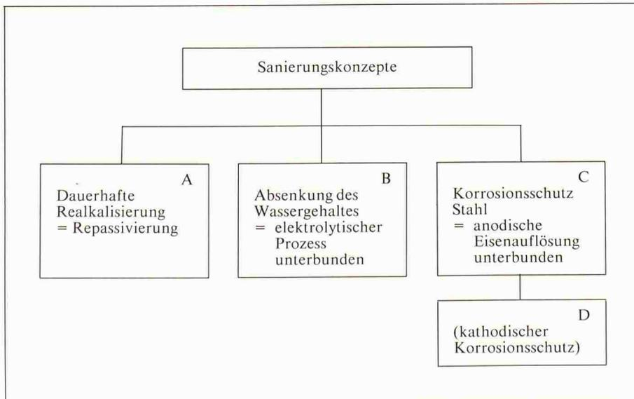
Bild 2. Ursachen der Korrosion und Sanierungskonzepte (Schliessl, P.)
