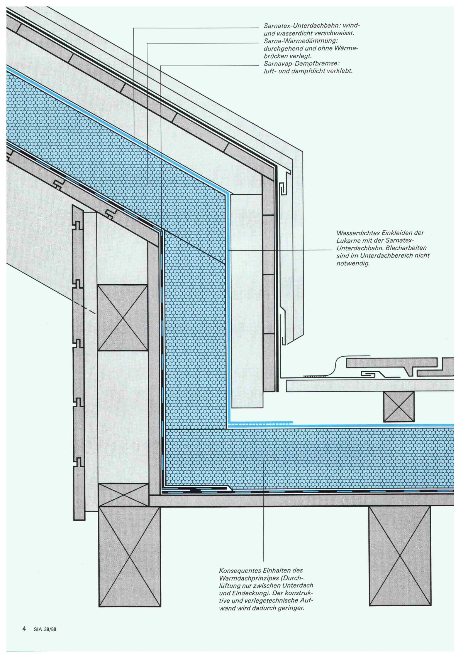
*Sarnatex-Unterdachbahn: wind- und wasserdicht verschweisst.
