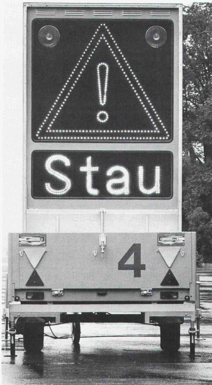
transportieren und damit in kurzer Zeit überall dort einsetzbar, wo gerade Stausituationen auftreten oder erwartet werden. Hier sind sie blitzartig aufgestellt. Danach können sie über Funk je nach Bedarf ein- und ausgeschaltet werden. Eine weitere Leistung von Sauber + Gisin im Dienste der allgemeinen Verkehrssicherheit.
