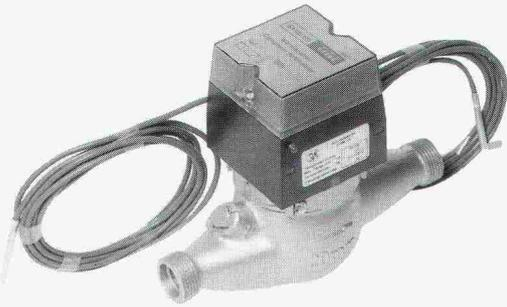
Wärmezähler SVME 69 Stromunabhängiger elektronischer Kompakt-Wärmehzähler mit Langzeitbatterie. Anzeigeteil für Wandmontage abnehmbar. Wasserzähler für waagrechten oder senkrechten Einbau. Kleinste Abmessungen. Grössen DN 15–32 mm.
