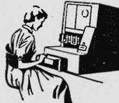
Recordak Reliant Filiesband - Microfilmcamera für 16mm Film mit 24, 32 und 40 facher Verkleinerung. Photographiert automatisch Vorder- und Rückseite eines Dokuments nebeneinander auf den Film. Automatische Dokumentenführung.
