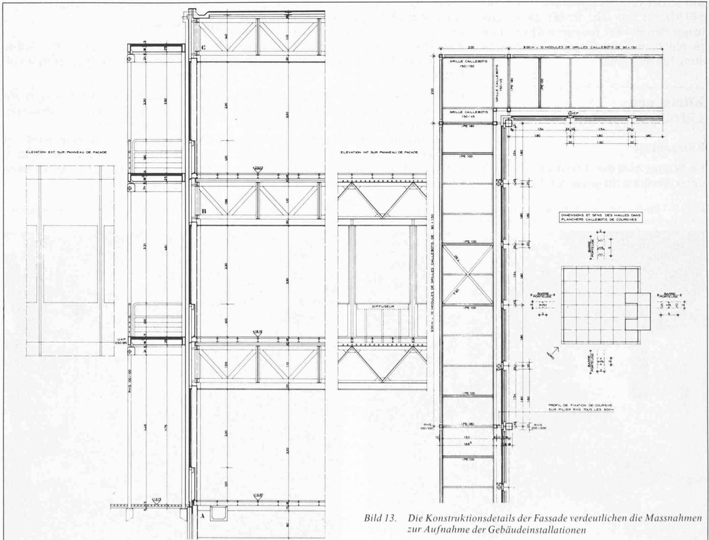
Bild 13. Die Konstruktionsdetails der Fassade verdeutlichen die Massnahmen zur Aufnahme der Gebäudeinstallationen
