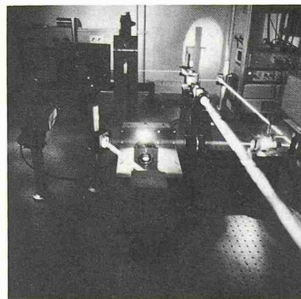
Ein Team von Physikern, Bauingenieuren und Softwarespezialisten hat mit Unterstützung der Eidg. Kommission zur Förderung der wissenschaftlichen Forschung (KWF) an der ETH Zürich dieses Laser-Interferometer gebaut. Vorn im Bild das Untersuchungsobjekt, ein noch nasser Betonklotz, der für die Hologramm-Aufnahme von einem Laserstrahl beleuchtet wird. (Bild: H. Bramaz)
