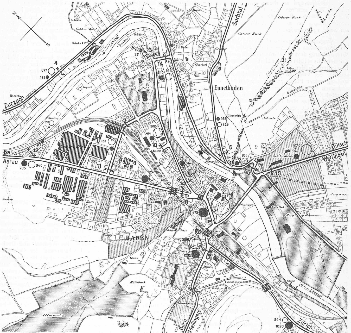
Verkehrsplan der Stadt Baden und Umgebung, Masstab 1:10000. — Die vorhandenen Niveau-Uebergänge sind als Gitter eingezeichnet; die Zahlen bei den vollen Kreisen bezeichnen die Anzahl Personen- und Last-Automobile, jene bei den leeren Kreisen die Anzahl Fahr- und Motorräder, die am 25. November 1929 zwischen 6 00 und 7 30 h an den Stellen x—x gezählt worden sind. Der starke Fahräderverkehr rührt von den vorwiegend im Süden der Stadt wohnenden Arbeitern und Angestellten her.
