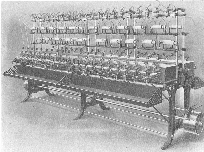
Abb. 3. Kreuz-Schuss-Spulmaschine „Klein-Rapid“ der Maschinenfabrik Schweiter A.-G., Horgen.
