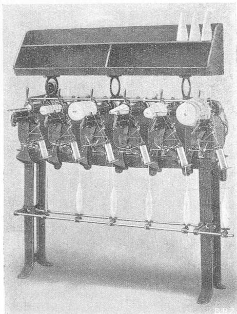
Abb. 1. Präzisions-Kreuzspulmaschine „Reform“.
