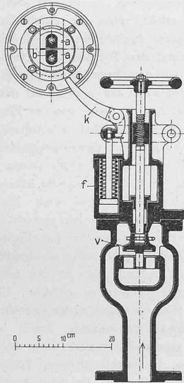
Abb. 6. Sicherheitsregulator mit Schnellschlussventil. Masstab 1 : 10.
