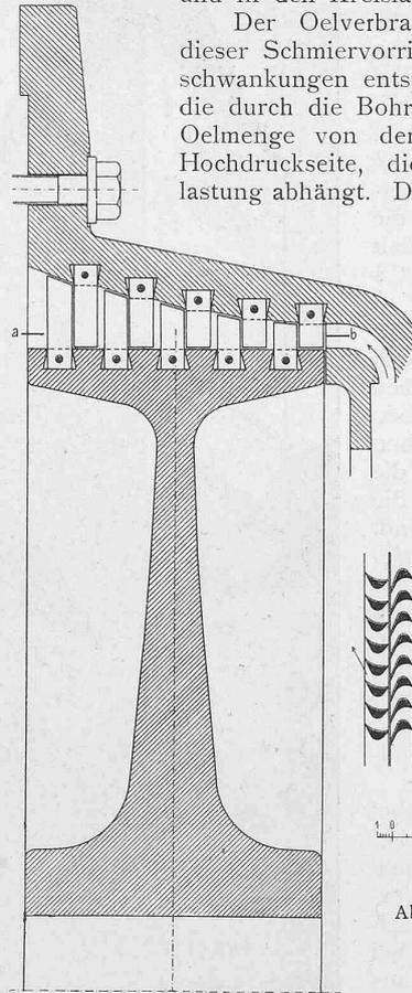
Abb. 7. Reaktionsrad und Schaufelung. Masstab 1 : 5.
