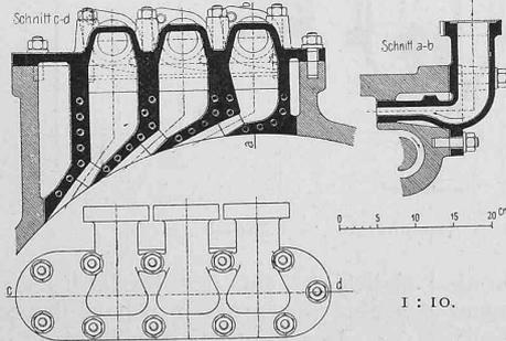
Abb. 2. Düsenapparat.
