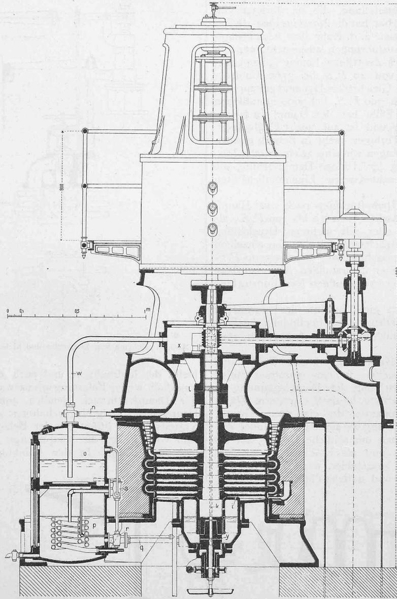
Abb. 5. Vertikale «Union»-Dampfturbine. — Masstab 1 : 25.
