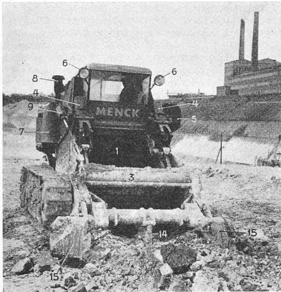
Bilder 2 und 3. Die Schürfkübelraupe in Tätigkeit (Legende s. Bild 1)
