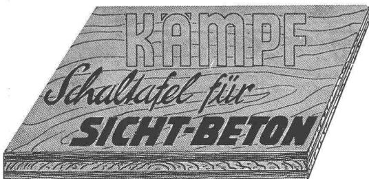
3-schichtig, querverleimt, 28 mm stark. Fabrikationsgrösse 100 x 500 cm oder auf kleinere Masse zugeschnitten. Ueber 50mal verwendbar.
