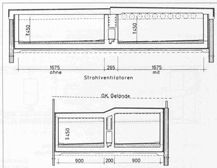
Bild 1. Alleetunnel (A66) in Frankfurt. 8- und 4streifiger Querschnitt
