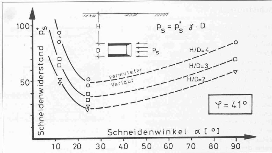
Bild 6. Rohrvorpressung. Schneidenwiderstand in Funktion des Schneideneinschnittswinkels (dichter Mittelsand)
