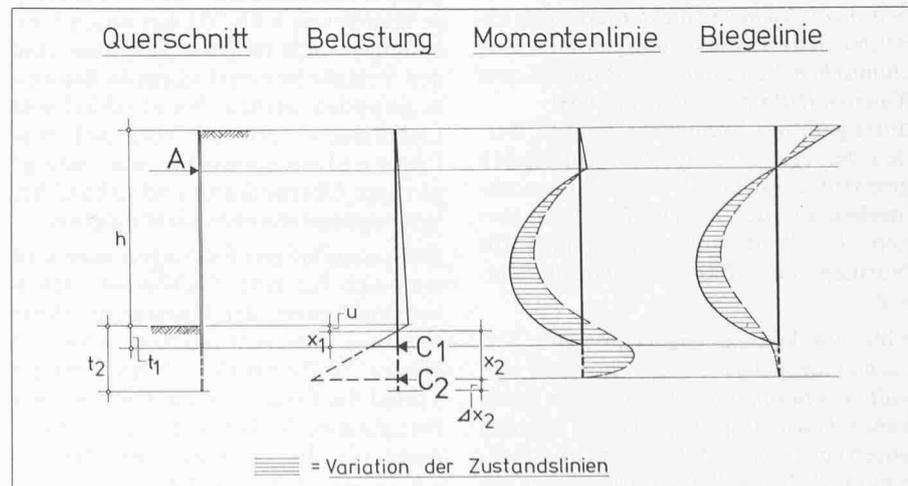
Bild 20. Einfach gestützte Baugrubenwand. Aufgabenstellung für zu ermittelnde Grössen
