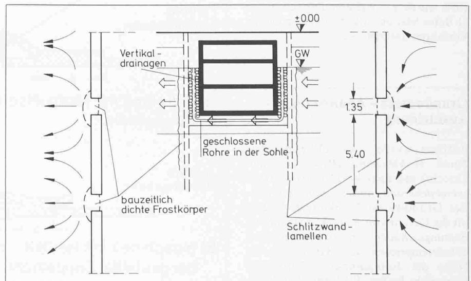
Bild 13. Bodengefrierung. Funktionsweise der in Duisburg angewandten Lückenvereisung
