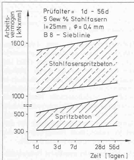
Bild 18. Spritzbeton und Stahlfaserspritzbeton. Vergleich des Arbeitsvermögens
