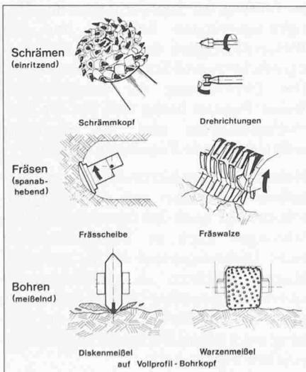
Bild 11. Mechanisches Lösen von Festgestein im Tunnelbau
