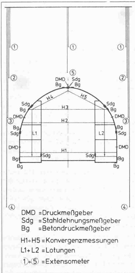
Bild 21. Stadtbahn Mülheim (Ruhr). Messquerschnitt eines Bauleses
