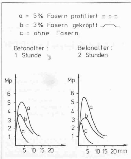
Bild 17. Lastverformungsverhalten von Stahlfaserspritzbeton im Bereich der Frühfestigkeit
