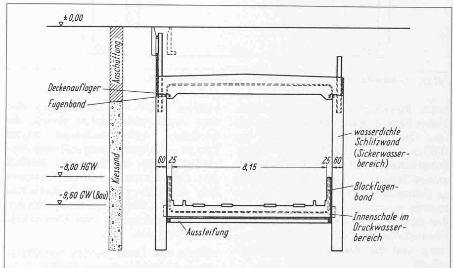
Bild 9. Schlitzwandbauweise. Wasserdichte Schlitzwand mit Fugenband und Innenschale
