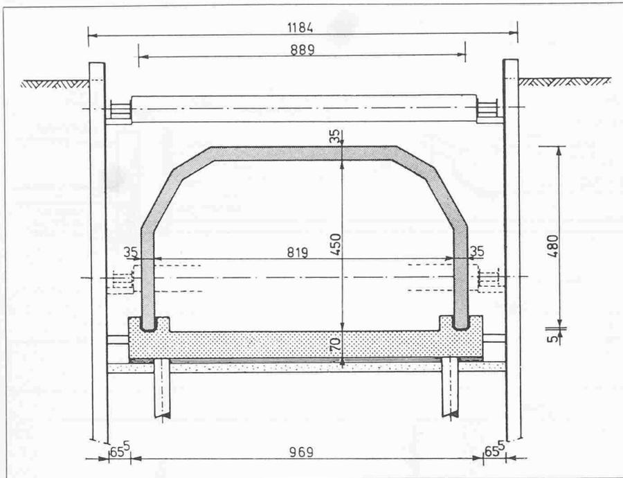
Bild 10. U-Bahn-Bau Rotterdam. Schalentunnel aus vorgefertigten Teilen
