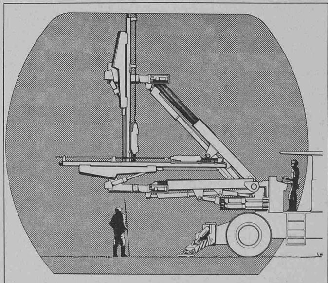
Fa. Normet verwendet. Ein 6-Zylinder-Diselmotor mit 74 kW Leistung verleiht dem etwa 35 t schweren Fahrzeug eine Steigfähigkeit von 30%. Je
