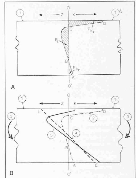
Bild 1. Diagramm der in einem auf der Oberseite nach dem Shot-peening-Verfahren behandelten Träger oder der in einem rechteckigen Balken auftretenden Zug- und Druckspannungen.
