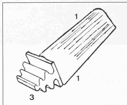
Bild 27. Unterschiedlich zu behandelnde Zonen an Turbinen und Kompressoren-Schaukeln. 1: eigentliche Arbeitsflächen der Schaufeln; 3: Wurzelende der Schaufel (sogenannter «Tannenbaum»).
