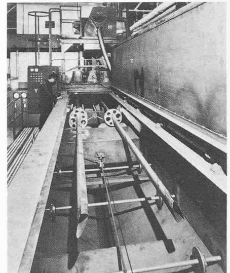
Bild 16 B. Blick in die geöffnete Beladestation der Anlage zum Shot-peenen von Helikopter-Propellern. Arbeitsweise siehe Diagramm Bild 16. Bei geöffnetem Deckel der Beladestation sind die beiden Propeller mit den aufgesteckten Mitnehmerscheiben «U» auf den beiden Walzenpaaren des Werkstückwagens aufliegend gut zu sehen. Im Hintergrund das Gehäuse des Schleuderrades und darüber der Hochleistungs-Kaskaden-Abscheider für die Aufbereitung des Strahlmittels.
