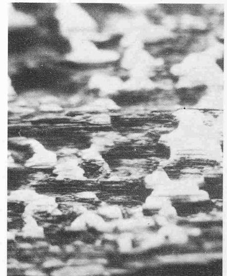
Bild 1. Oberflächliche Holzerosion durch Solarstrahlung, Bläuepilze und Regen
