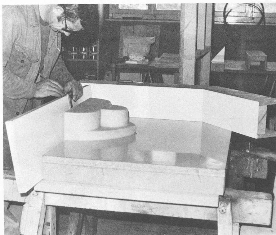
Fig. 5. — Moule adaptable pour les arcatures en contre-plaqué stratifié, voûte en silicone souple.
