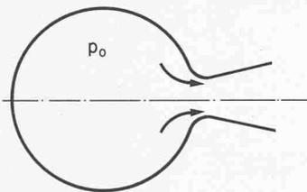
Bild 1. Ausströmen von Gas aus einem Behälter, der mit dem Druck  $p_0$  gefüllt ist, durch eine Düse hindurch. Am Ende der Düse herrscht ein Druck, der niedriger ist als der Kessel- $p_0$ . Die Pfeile geben die Strömungsrichtung an
