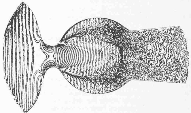
Bild 6a. Gleicher Vorgang wie in Bild 6, aufgenommen mit einem weiterentwickelten Interferenzverfahren, das auch quantitative Auswertungen schnell ablaufender Strömungsvorgänge erlaubt. Deutlich erkennbar ist die Turbulenzentwicklung, also der Übergang von Strömungsenergie in Wärme
