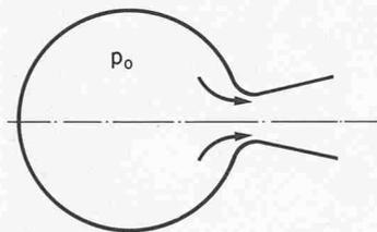
Bild 1. Ausströmen von Gas aus einem Behälter, der mit dem Druck  $p_0$  gefüllt ist, durch eine Düse hindurch. Am Ende der Düse herrscht ein Druck, der niedriger ist als der Kessel- $p_0$ . Die Pfeile geben die Strömungsrichtung an
