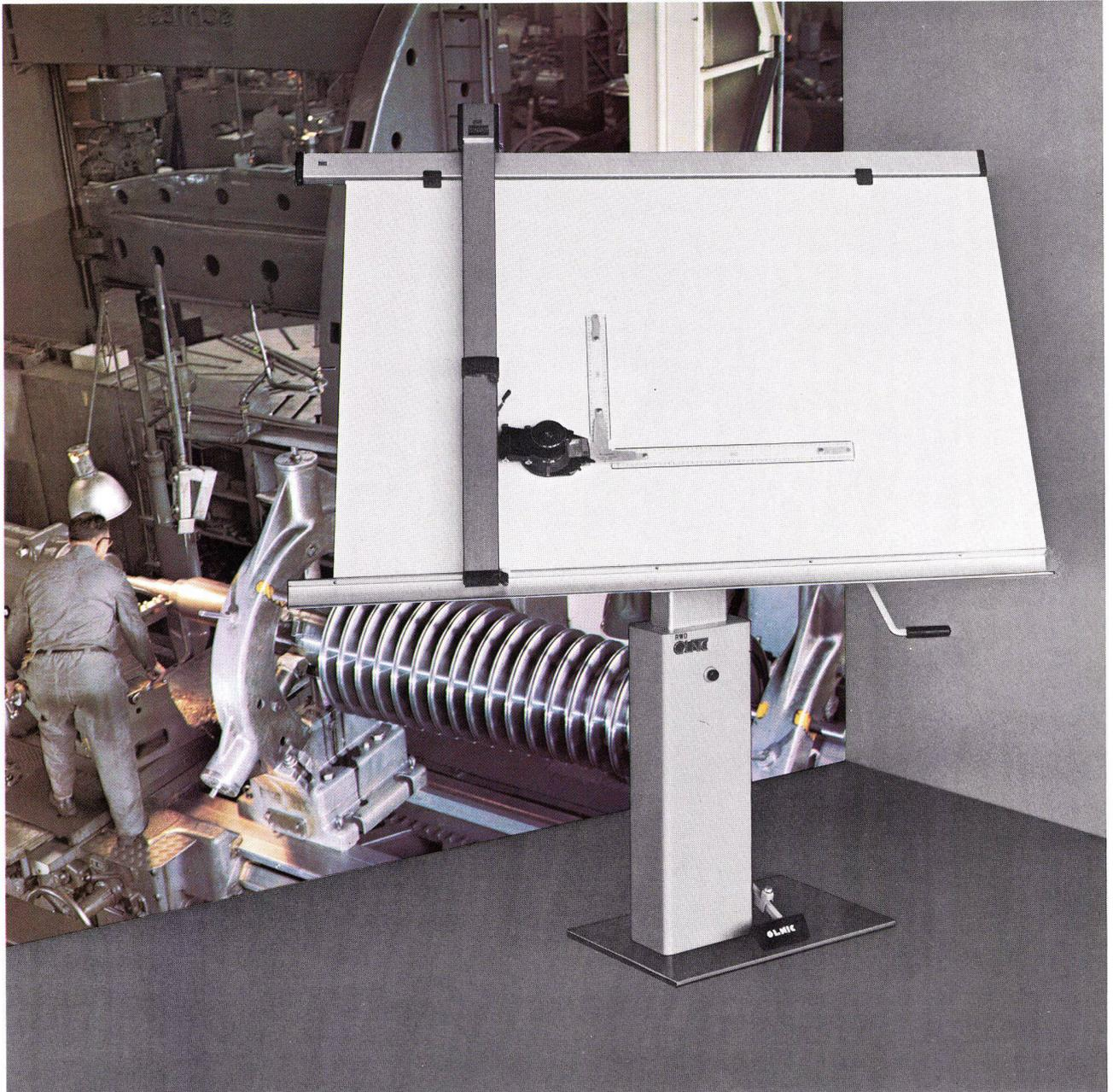
Die Höhenverstellung des Reissbrettes dieses Einsäulenzeichenständers erfolgt mittels einer ausgleichenden Gasfeder, welche durch ihre ingenieure Konstruktion ein Gegengewicht oder eine bemühende Pump-Hydraulik vermeidet. Das Reissbrett ist 360° drehbar und kann in der Mitte oder auch asymmetrisch angebracht werden. Dadurch wird dieses Zeichengerät innerhalb eines L- oder U-förmigen Arbeitsplatzes beliebig und am besten Platze angebracht. Diese technische Ideallösung gibt es in
