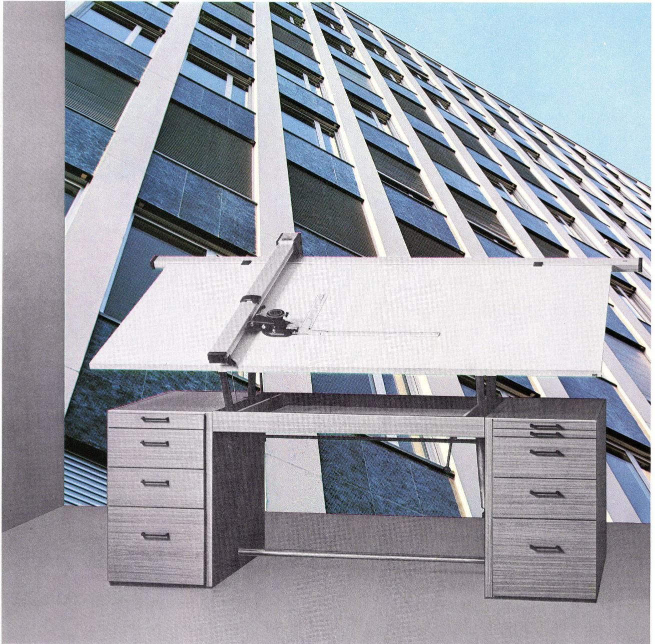
Dieses in Höhe und Schräge verstellbare Zeichenpult ist der ideale Arbeitsplatz für Architekten, Ingenieure, Techniker, Zeichner und Studenten. Das Reissbrett von 120 cm x 80 cm bis 200 cm x 100 cm Grösse kann mittels Federausgleichs stufenlos von 75 cm Höhe bis 110 cm angehoben und in der Schräge bis 60° geneigt werden. Für schwere Zeichenmaschinen können 2 Gasfedern angeflanscht werden. Das ganze Pult ist allseitig mit Pirelli-Kunststoff beschichtet (Nr. 14 hellgrau oder Nr. 80 Nussbaum).
