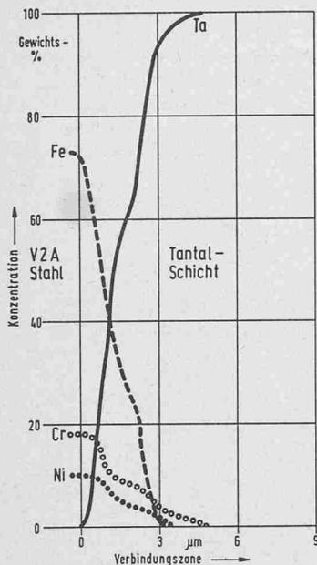
Konzentrationsverlauf von Ta, Fe, Cr und Ni in der Verbindungszone zwischen V2A-Stahl und Tantalschicht. Schon bei einer Schichtdicke von  $3 \mu$  Tantal ist der Tantalanteil in der Verbindungszone auf rund 95 % gestiegen. Ab  $5 \mu$  ist auch der Chromanteil in der Verbindungszone nicht mehr nachweisbar. Die Oberfläche des Werkstücks verhält sich wie reines Tantal. Die Abscheidungstemperatur betrug bei dem Versuch 1370 K.
