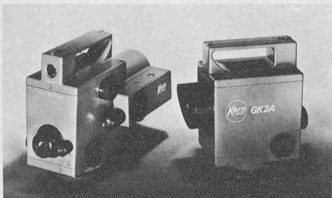
ohne Mikrometer genügt für alle Höhenmessungen im Ingenieurbereich. Mit optischem Mikrometer und Invarmire wird das GK 2-A zum Präzisionsnivellier. Bezüglich Ausstattung und Zubehör ist das GK 2-A im Bau, in der Vermessung und in der Industrie für alle Nivellements bestens geeignet.
