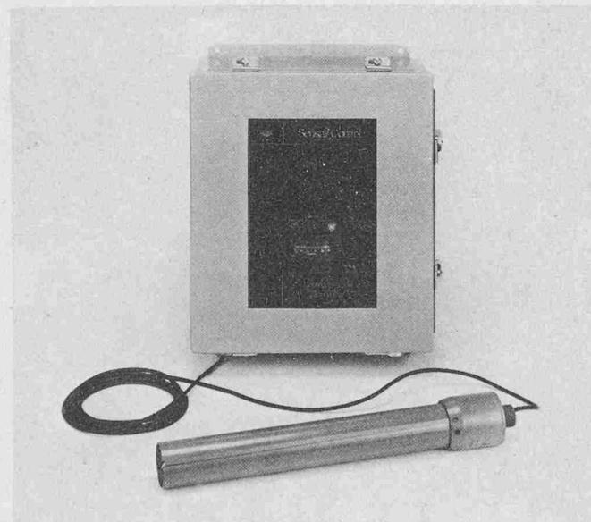
Das Mobrey Sensall System 8100 bietet aber noch weitere Vorteile: drei Messbereiche (1,5; 3,0 oder 6,0 m), wobei innerhalb des gewählten Bereiches nochmals gespreizt werden kann. *Nahbereichsanzeige*, die anspricht, wenn die Flüssigkeit bis auf 89 mm an den Fühler steigen sollte (Notalarm). *Echoverlustanzeige* falls das Flüssigkeitsniveau für länger als 9 s unterhalb des erfassten Bereiches fällt. *Stromausgang* (0-20, 4-20, 1-5 oder 10-50 mA) zum Anschliessen von Fernanzeigen usw.
