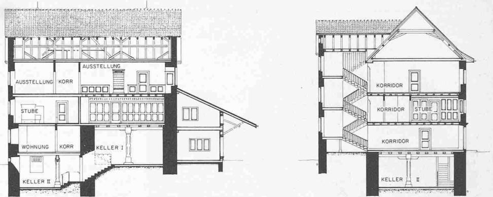
Unten: Querschnitt, erstes und zweites Obergeschoss des Scheunenneubaus 1:350
