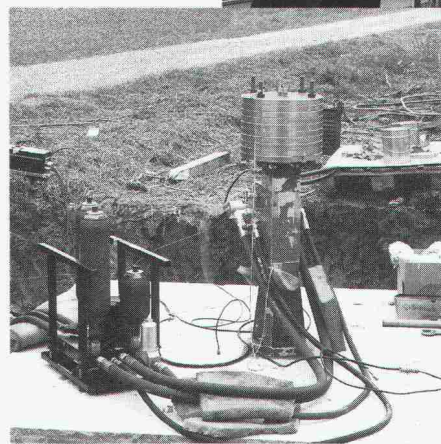
Schwingungserregung einer Fundamentplatte.
