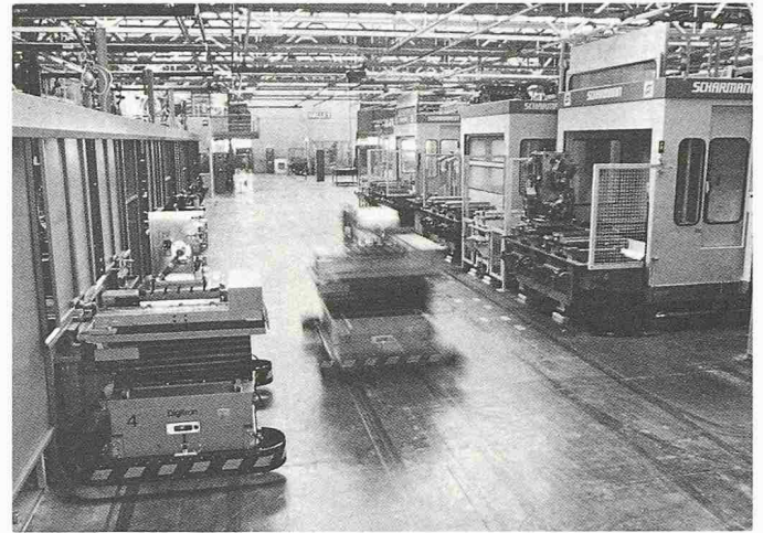
Bild 4. Teilefamilie Gehäuse: Flexibles Fertigungssystem geliefert von der Firma Scharmann. Links das zentrale Werkzeugmagazin, in der Mitte die computergesteuerten Transportfahrzeuge und rechts die Bearbeitungszentren
