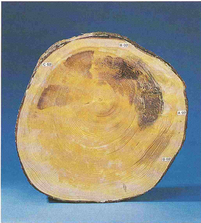
Bild 2a. Stammfäule in einer Fichte
