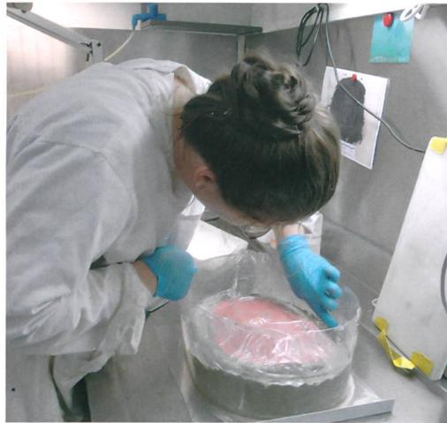
Abb. 4: Anfertigung einer passgenauen Schutzkappe für die Blockoberseite. Die Schutzkappe besteht aus einem Silikonkuguss, der sich exakt an die Objektoberfläche anlegt. Zur Stabilisierung erhielt die Kappe einen Sockel aus einem Epoxidharz-/Styroporkugelmischung.
