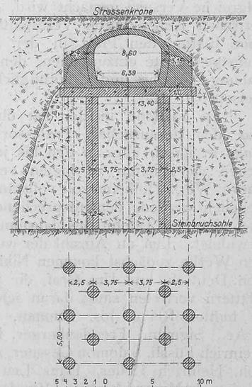
Abb. 12. Tunnel über einem Steinbruch mit eingesunkener Decke. — 1 : 500.
