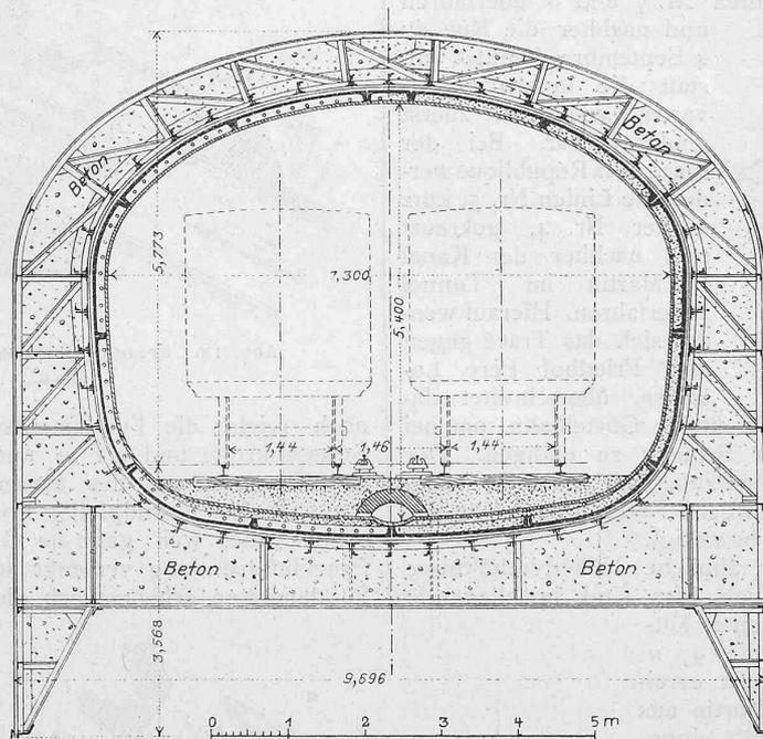
Abb. 20. Querschnitt des Tunnels unter der Seine für die Linie Nr. 4.
