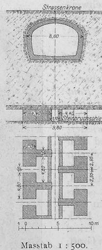
Abb. 11. Sicherung des Baugrundes über einem Steinbruch.
