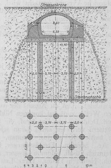
Abb. 12. Tunnel über einem Steinbruch mit eingesunkener Decke. — 1 : 500.
