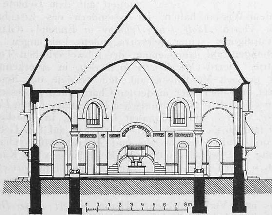
Querschnitt durch die Kirche. — Masstab 1 : 300.
