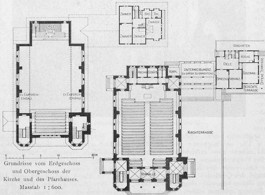
Grundrisse vom Erdgeschoss und Obergeschoss der Kirche und des Pfarrhauses. Masstab 1 : 600.
