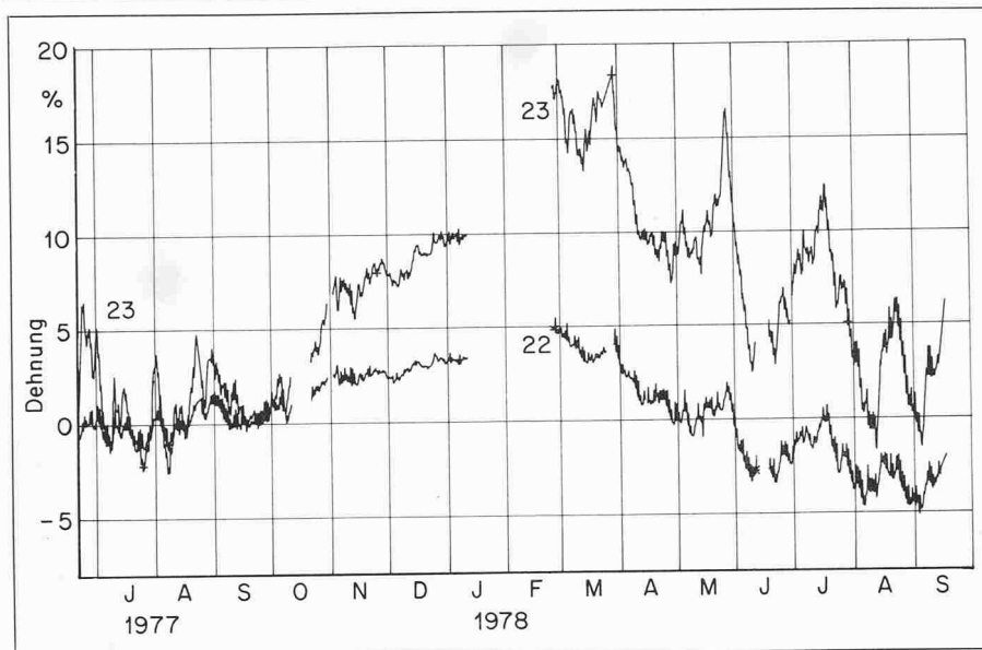
Bild 10. Zeitlicher Verlauf der schwind- und quellbedingten Dimensionsänderungen (Sonnenseite) am angestrichenen (Kurve 22) und am unbehandelten (Kurve 23) Balkenende bei direkter Bewitterung
