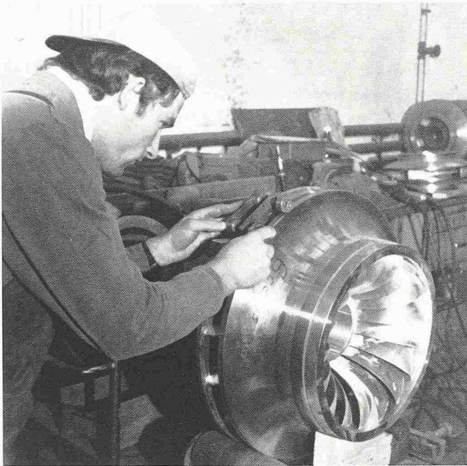
In das EW Feusisberg wird eine Francis-Turbine eingesetzt
