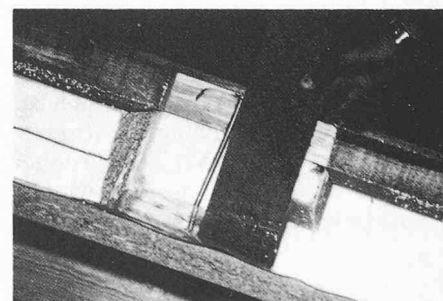
Bild 5. Ausschnitt aus dem Versuchsmodell mit sichtbarer Deformation eines Konterlattennagels in einem über den Sparren wärmedämmten System
