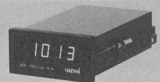
Das elektronische Barometer misst den Luftdruck (umgerechnet auf Meereshöhe) im Bereich von 960 bis 1060 mbar oder den Absolutdruck von 700 bis 1100 mbar.
