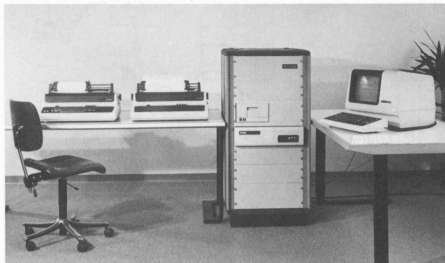
Bild 3. Zentraleinheit mit Bildschirmarbeitsplatz, Journal- und Alarmdrucker
