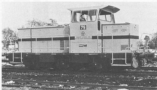
Bild 10. Diesel-Industrie-Rangierlokomotive DE 500, 500 kW Leistung
