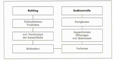
Tabelle 2. Fertigungsablauf eines einfachen Bimetallzylinders
