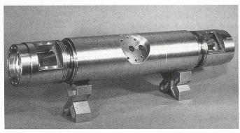
Bild 2. Extrusionszylinder in Bimetallausführung. Die Panzerschicht bedeckt die Innenoberfläche des Zylinders
