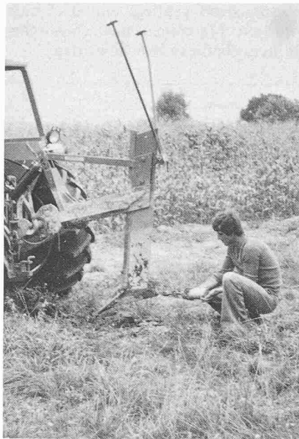
Bild 7. Maulwurfdrainage mit Traktor als Zugmaschine
