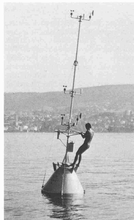
Bild 13. Messung von Wind, Lufttemperatur, Luftdruck, Luftfeuchtigkeit und Strahlung als Einflussgrössen der Seeströmungen. Meteoboje auf dem Zürichsee
