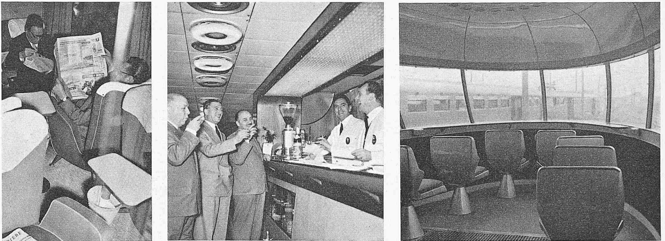
Fig. 12 à 14. Electrotrain de luxe type ETR 300 des FS: fig. 12: compartiments doubles à couloir latéral (chaque compartiment offrant 10 places est meublé de deux canapés à trois places chacun et de quatre fauteuils mobiles). fig. 13: le bar. fig. 14: belvédère, situé à chaque extrémité de la rame.
