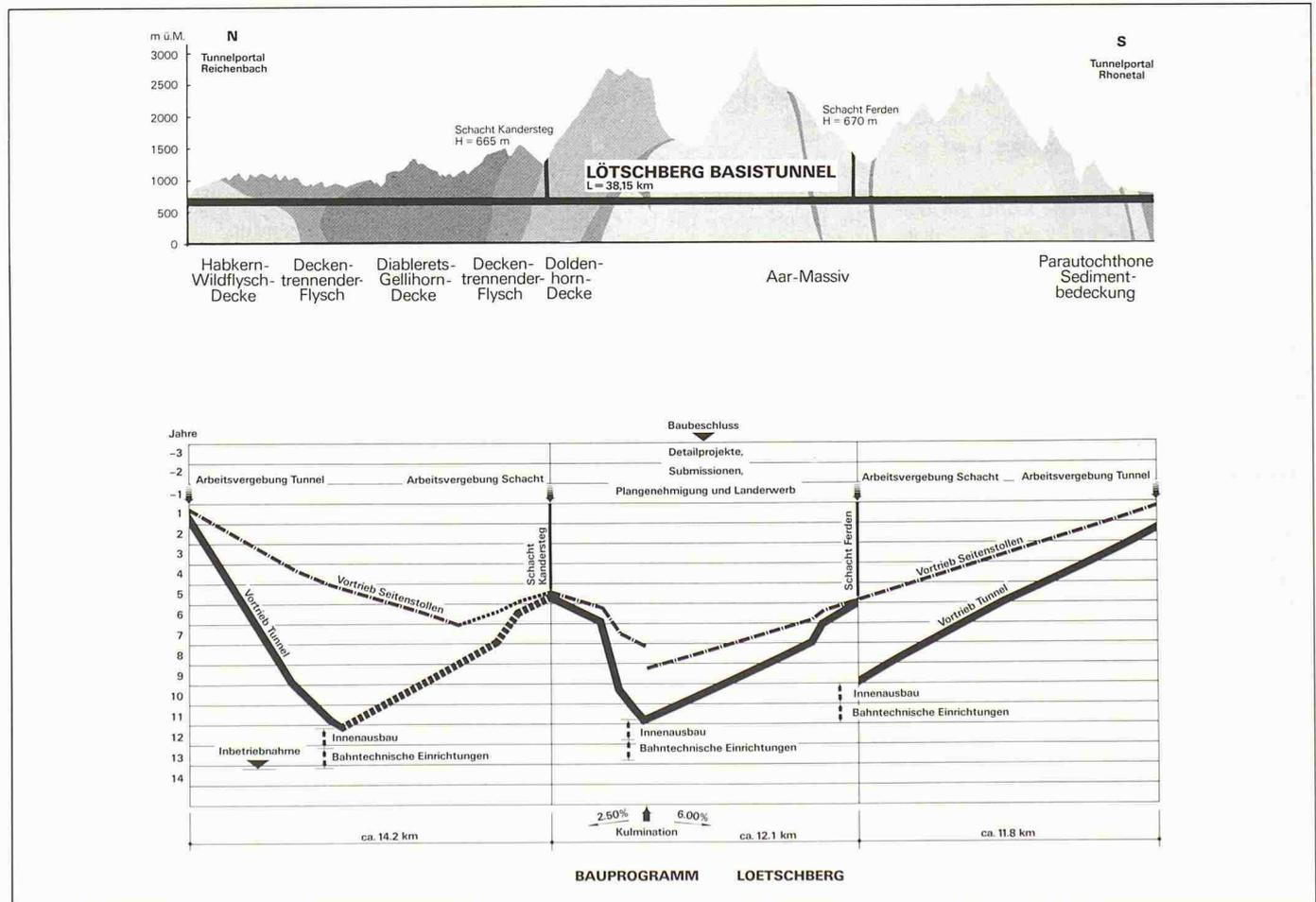
Bild 4. Bauprogramm Lötschberg-Basistunnel
