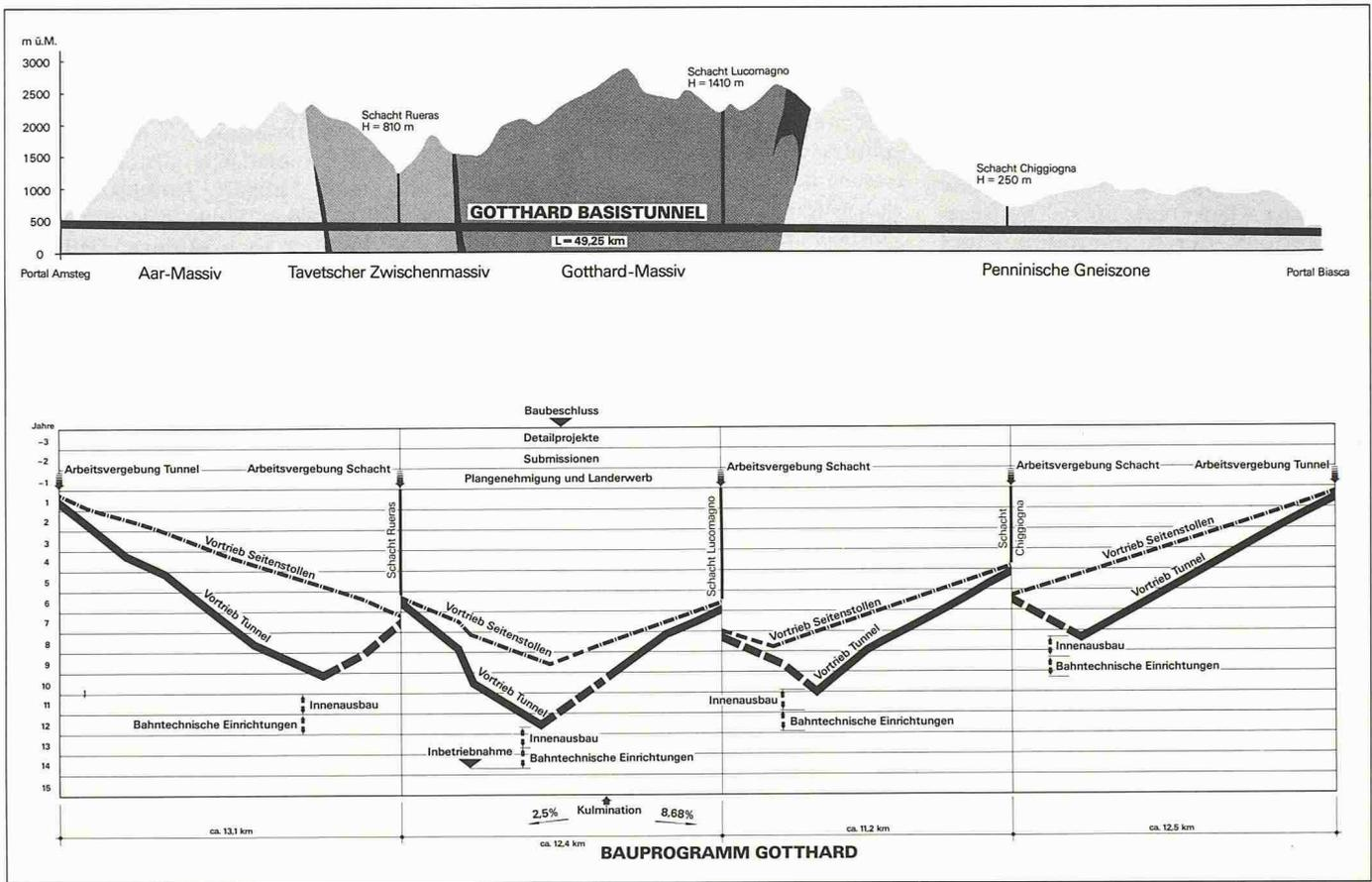
Bild 3. Bauprogramm Gotthard-Basistunnel
