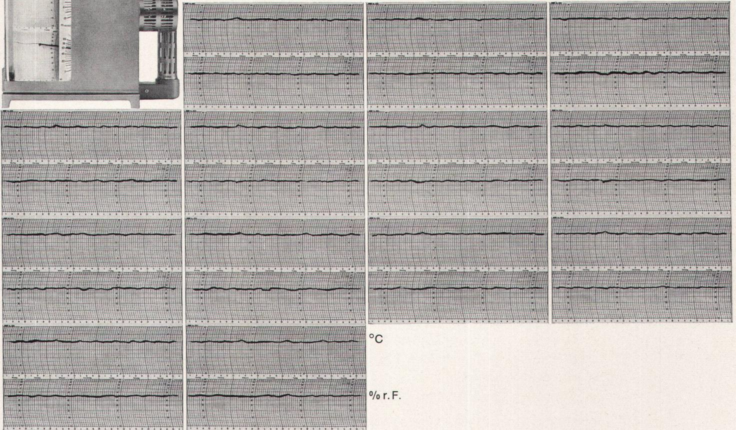
zum Beispiel in einem Raum ganzjährig die Toleranzen der Temperatur innerhalb von  $\pm 1$  °C und diejenigen der Feuchtigkeit bei  $\pm 3\%$  r.F. halten (und dies mit einer Standardanlage).
