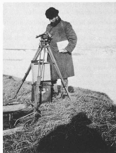
Bild 6. E. K. Weber führt im Frühjahr 1910 am Kap Deschnew, während er auf das Schiff aus Wladivostok wartet, eine astronomische Ortsbestimmung mit dem Universalinstrument aus
