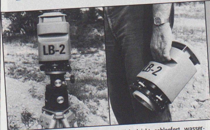
Das Nivelliersystem für den Polier; der Dioden-Rotorlaser für jeden Bau
