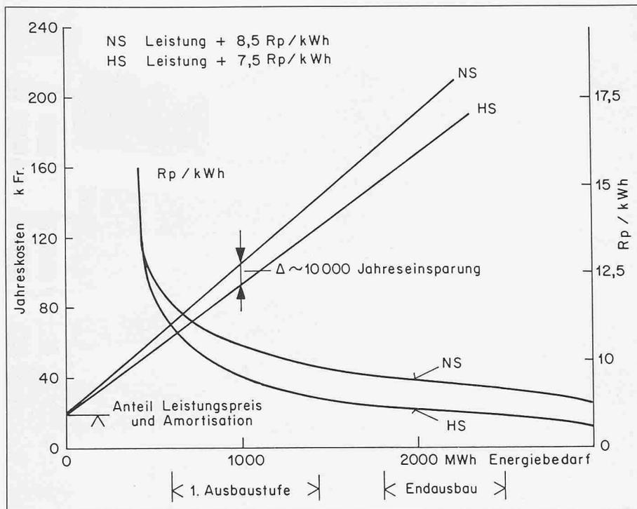
Bild 1. Kostenamortisation der Trafostation
